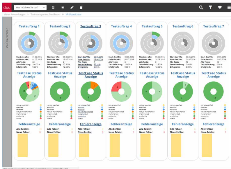
1 Die Plattform Cluu dient als zentrale Datendrehscheibe und als Report-Dashboard für die CI-Testing-Toolkette.
